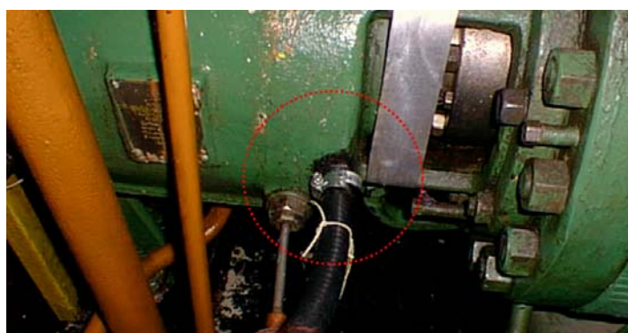
Рис. 5-7. Установка стационарных датчиков ударных импульсов SPM (примеры).
