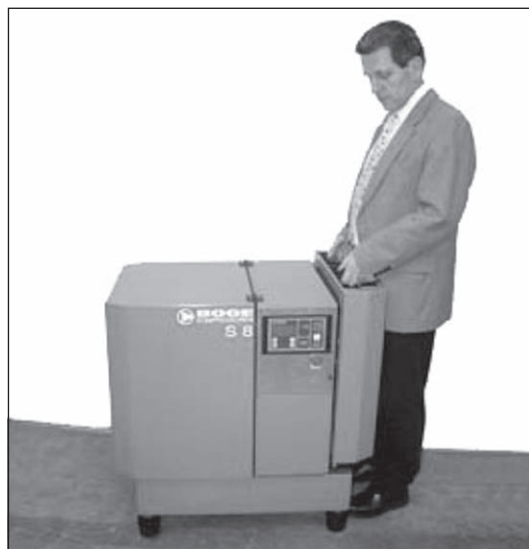
Рис. 3.1: Снятие кожуха теплого воздуха
