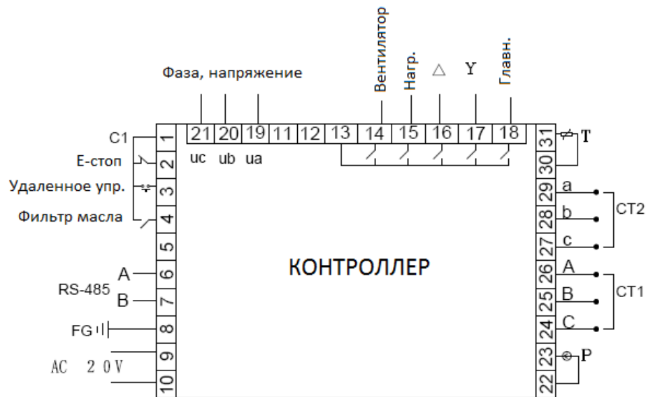
Рисунок 4.2.1 Схема расположения клемм
